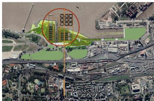
El plan constructivo dispone de una visión conceptual general, el cual se desarrolla a partir de una planta base en deck de madera montada en pilotes, elevada tanto sobre la tierra, como el agua, entendiéndose a esta operación como la primera capa de la ordenación general.
